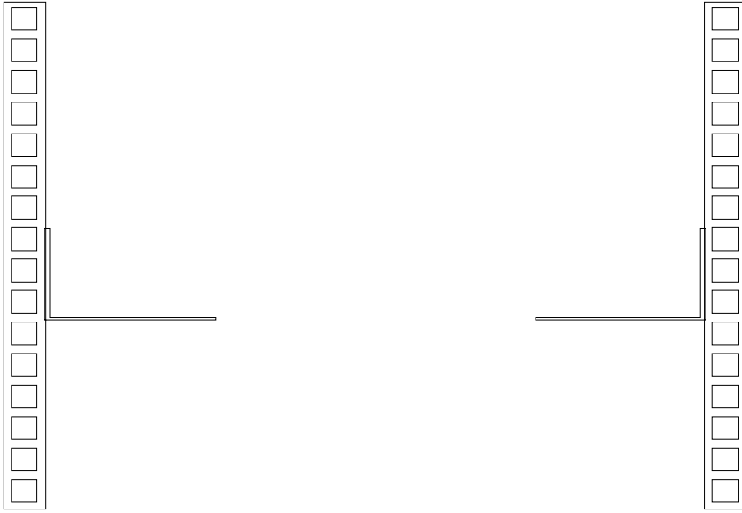
그림 6. 지지용 브라켓 설치
