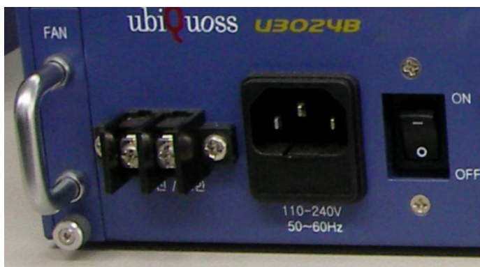
그림 1-2. U3024B 전원/FAN UNIT 블록
