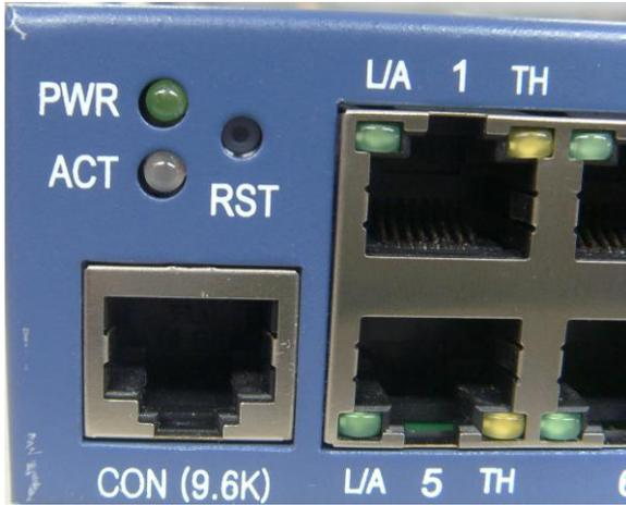
그림 7. 시스템 상태 LED 전면형상
