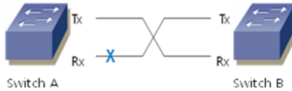
그림 7-1 UDLD detection of a Unidirectional Link
