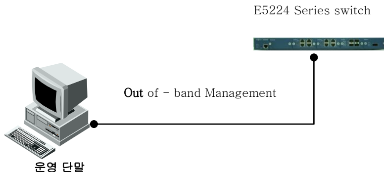
그림 2-1. E5224 Series 스위치와 운영 단말 연결
