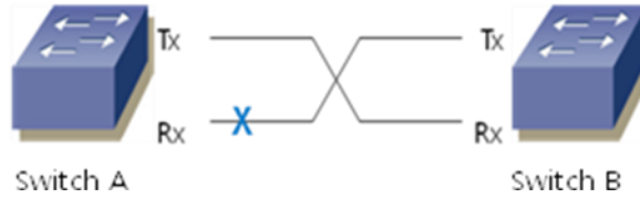
그림 7-1 UDLD detection of a Unidirectional Link
