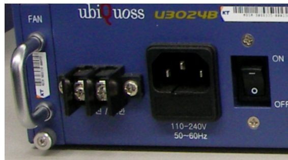
그림 2. U3024B 전원/FAN UNIT 블록
