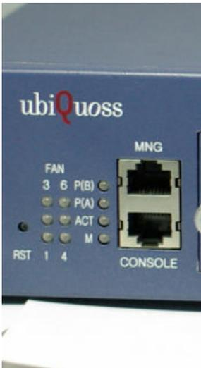
그림 7. 시스템 상태 LED 전면형상도
